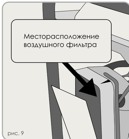
1. Сдвинув крепление, снимите крышку фильтра и извлеките фильтрующий элемент.
