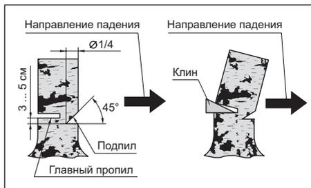
1) Выполните подпил на четверть диаметра ствола со стороны предполагаемого направления падения. Верхний пропил должен быть произведен под углом около 45°, нижний – горизонтально, таким образом, чтобы он пересекся с верхним и не был ниже него.
