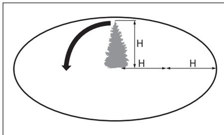
Перед началом валки дерева определите естественный наклон дерева и направление ветра, а также оцените расположение наиболее тяжелых веток и с учетом этих факторов определите направление падения дерева. Примите меры, чтобы в зоне его падения, не находились люди, животные, линии электропередач, телеграфные провода, строения, техника и иные объекты.
