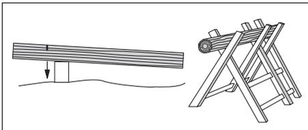
При пилении очень толстой или очень твердой заготовки делайте пропилы на глубину до 1/3 толщины и поворачивайте заготовку вокруг своей оси до полного распила.
