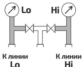
● Снимите заглушки с сервисных портов низкого и/или высокого давления холодильной машины и подключите шланги как указано выше.
