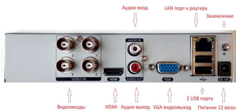
На задней панели регистратора расположен разъем питания, разъемы BNC, разъемы USB, разъем RJ45, RS-485 (опция), VGA, HDMI, входы/выходы тревоги (опция), входы/выходы звука (опция).
