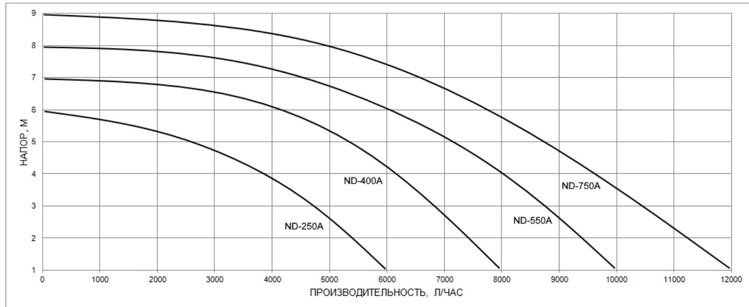
Приведенные характеристики справедливы при использовании патрубка G 1 ½" и трубопровода с диаметром условного прохода DN40, а так же с минимальными сопротивлениями потоку воды в напорной магистрали, при номинальном напряжении питания 220 В.
