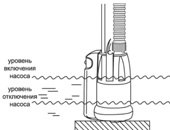
3.5.2. При эксплуатации насоса в вертикальном положении или в положении под наклоном, включать его в сеть допускается только, если его насосная часть погружена в воду не менее, чем на 10 см.
