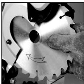
Открутите рычаг зажимного кожуха и снимите его. Ослабьте винт крепления кожуха и откиньте его вверх. Теперь у вас есть доступ к замене пильного диска.
