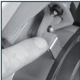
Кнопка блокировки шпинделя блокирует вращение пильного диска. Используйте кнопку блокировки шпинделя для установки, замены и снятия пильного диска.
