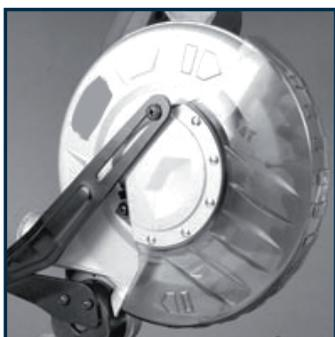
Подвижный защитный кожух обеспечивает защиту оператора. Кожух автоматически поднимается, когда пильная головка опускается вниз.
