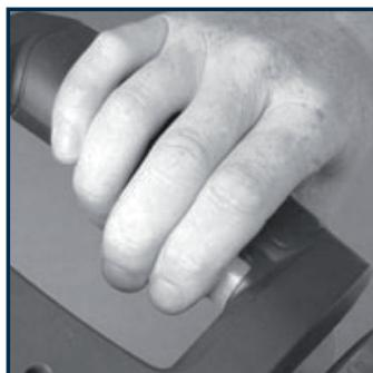
Нажмите кнопку включения для начала работы с торцовочной пилой. Для остановки торцовочной пилы отпустите кнопку включения.
