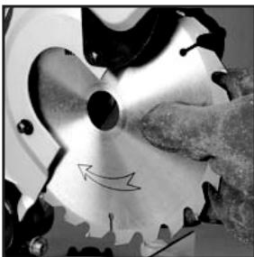
Открутите рычаг зажитного кожуха и снимите его. Ослабьте винт крепления кожуха и откните его наверх. Теперь у вас есть доступ к замене пильного диска.
