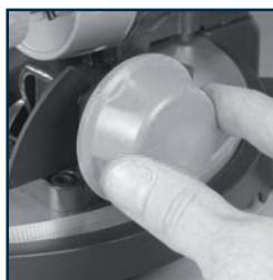
Ослабьте винт блокировки угла наклона пилы. Установите пильную головку под нужным вам углом. Затяните винт блокировки. Угол наклона пилы регулируется от 0° до 45° влево.
