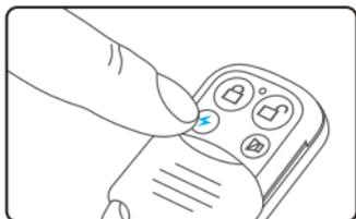
При нажатии кнопки экстренного вызова система переходит в режим аварийной сигнализации независимо от того, в каком режиме находится панель управления.
