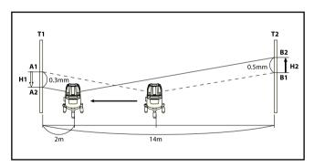
Поставьте прибор на расстояние ≥10 м от стены. Включите горизонтальную линию. Спроецируйте горизонтальный луч на стену и поставьте метку А1. Поверните инструмент на 90°, отметьте точку на левой стене меткой В2. Переставьте прибор
