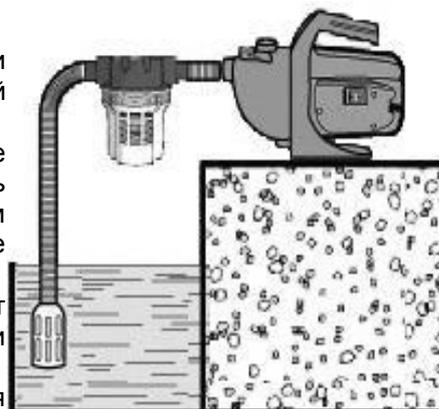
резьба насосной части 1'. В комплекте со станцией поставляются пластиковые штуцеры. С их помощью вы можете подключить к станции гибкие шланги. Не применяйте чрезмерную силу при их вкручивании, они могут треснуть и через трещину может происходить подсос воздуха, который резко снижает способность насоса осуществлять забор. Отдельно вы можете приобрести высококачественные латунные штуцеры производства Quattro Elementi.
