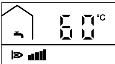
Температура котловой воды во время работы постоянно отображается на дисплее.
