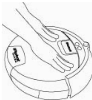
6. Нажав с небольшим усилием, установите резервуар на место, Вы должны услышать щелчок.
