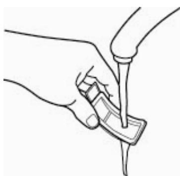
2. Промойте фильтр теплой водой.
