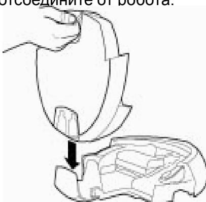
5. Убедитесь, что обе крышки резервуара плотно закрыты. Присоедините резервуар к базе, направив его вертикально в держатель с надписью Scooba.
