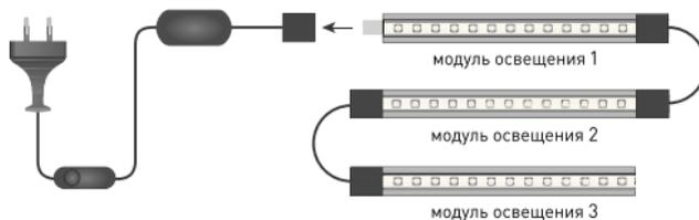
Монтаж и сборку модульной системы необходимо производить при отключенном питании.
