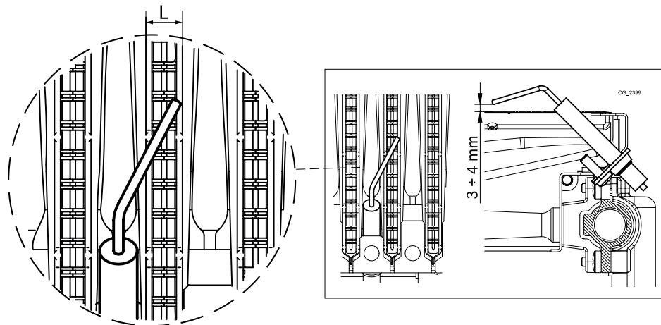
**⚠** Электрод должен полностью пересекать ширину (L) горелочной трубы.
