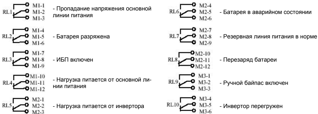
РИСУНОК 7: ОПИСАНИЕ ОТКРЫТЫХ КОНТАКТОВ РАЗЪЕМА DB9.
