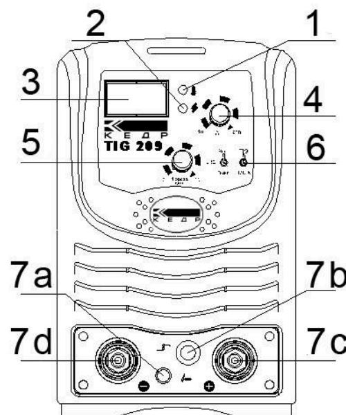
1. Сигнальная лампа 1. Светодиод загорается при включении аппарата в сеть.
