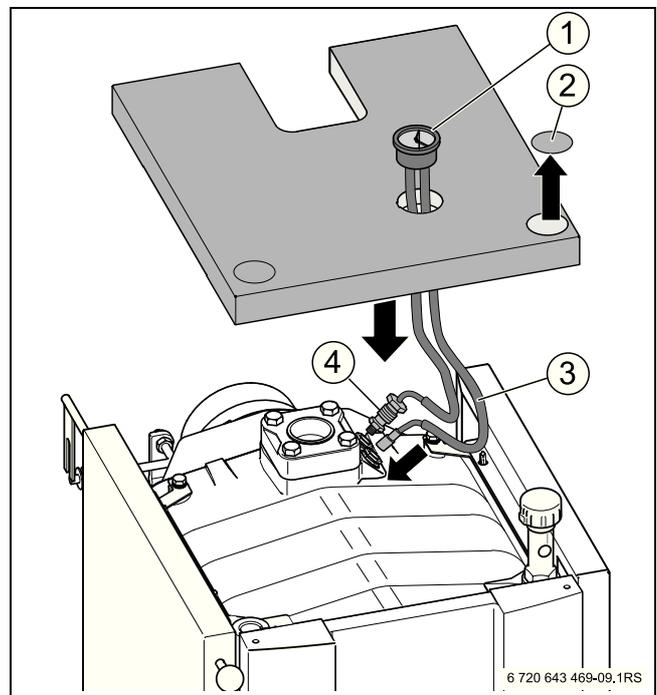
Рис. 13 Установка крышки котла и термоманометра
