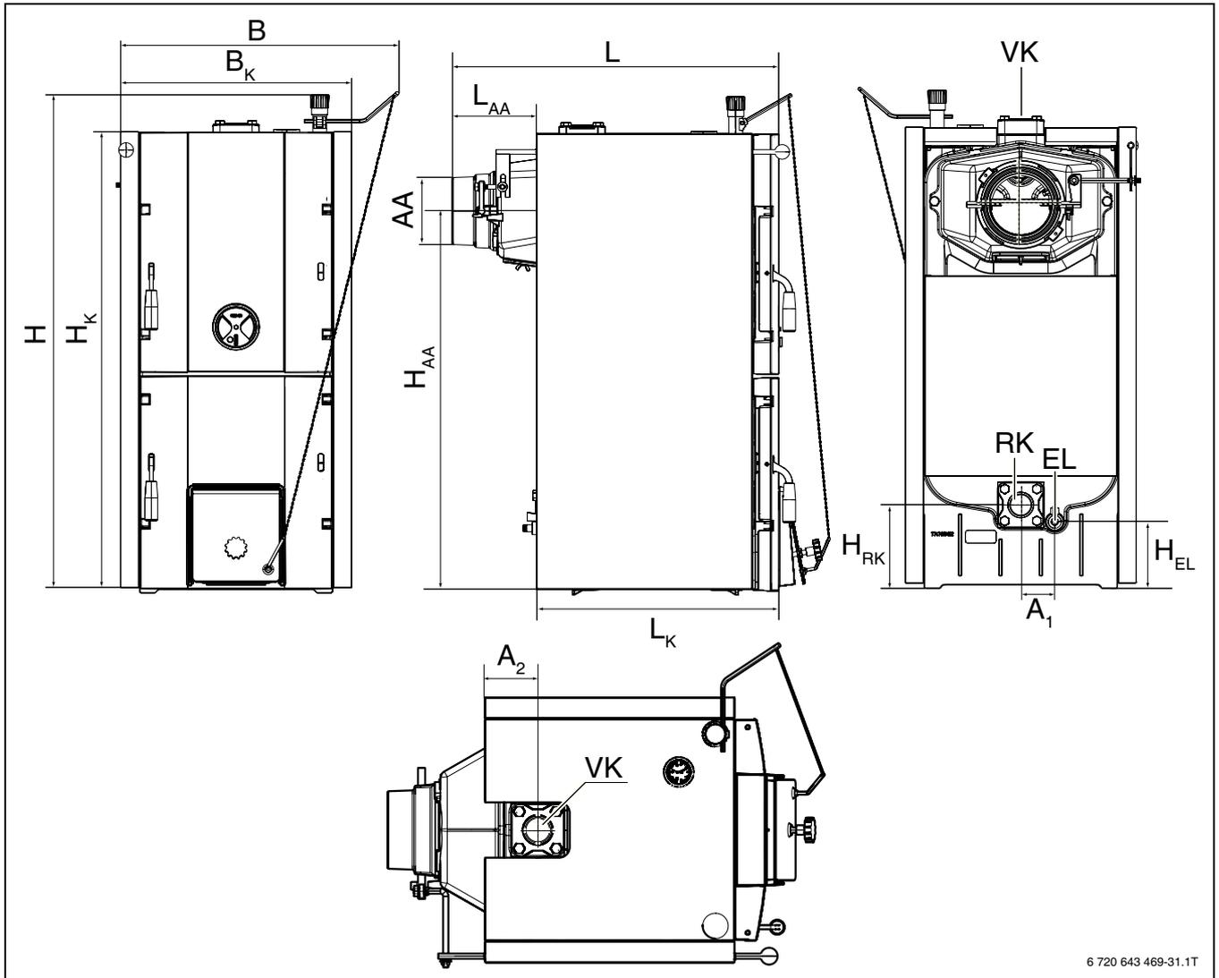
Рис. 4 Размеры и подключения
