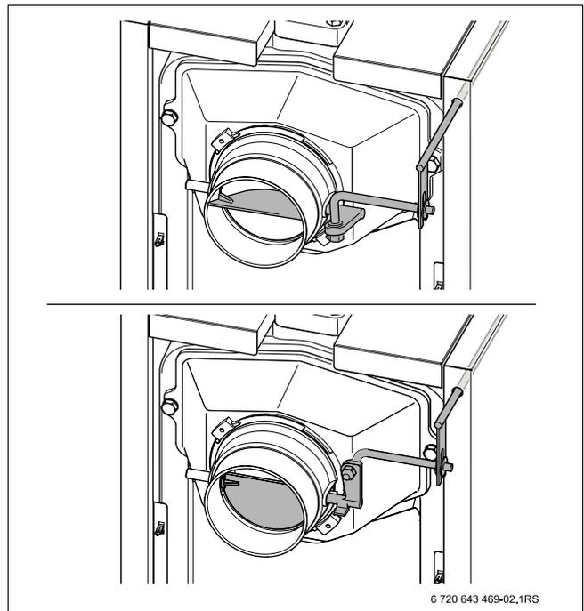
Рис. 2 Дымовая заслонка (вверху открыта; внизу закрыта)
