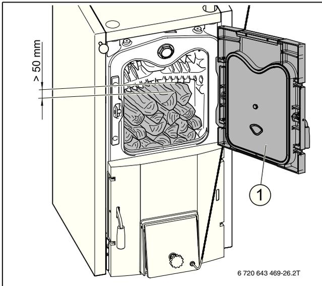
Рис. 32 Дозагрузка дров
