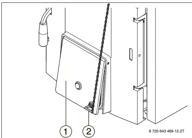
Рис. 15 Монтаж цепи регулятора и регулировка воздушной заслонки
