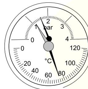
Рис. 24 Термоманометр
