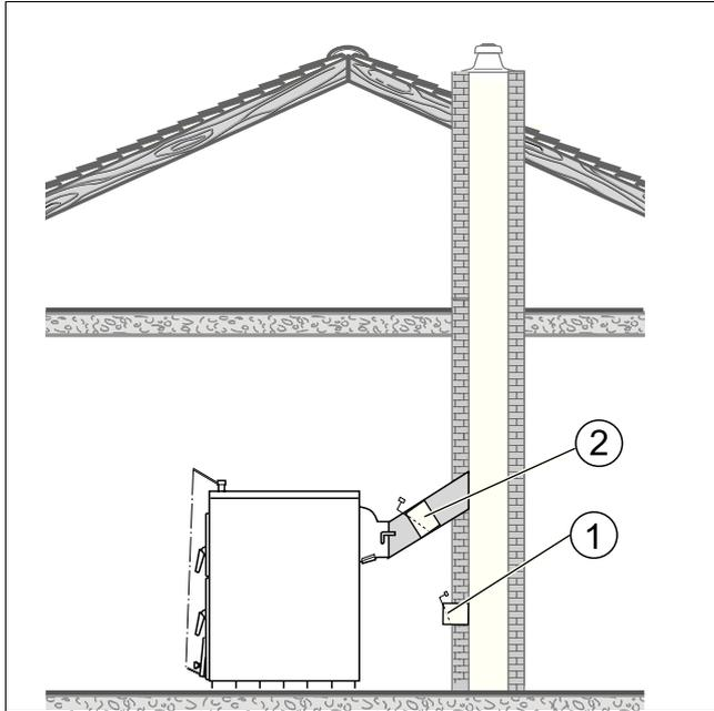
Рис. 21 Расположение ограничителя тяги / регулятора подачи дополнительного воздуха
