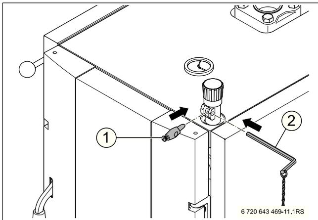
Рис. 14 Соединение регулятора горения с воздушной заслонкой
