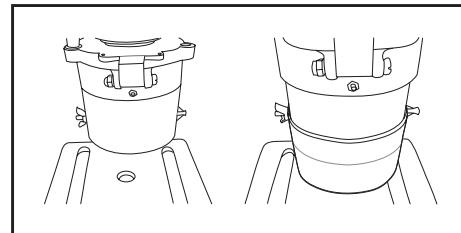
Для регулировки открутите боковые винты кожуха, отрегулируйте его длину и зафиксируйте необходимое положение, затянув винты.
