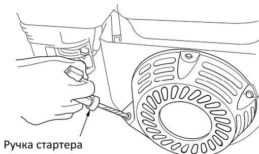
После запуска прогрейте двигатель примерно в течение одной минуты, открывая по мере прогрева воздушную заслонку. Отрегулируйте желаемые обороты двигателя с помощью рычага управления дроссельной заслонкой.
