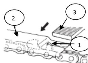
Контролируйте высоту ограничителя глубины резания с помощью специального шаблона (2). Выступающую часть ограничителя глубины реза (1) сточите с помощью плоского напильника (3).
