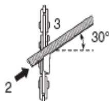
Диаметр напильника должен соответствовать шагу цепи. Заточку следует производить только при движении напильника изнутри наружу. Напильник снимает металл только при движении вперед. Строго выдерживайте величину режущего угла. При движе-
