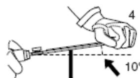
Держите напильник под углом  $10^\circ$  вверх. Напильник регулярно переворачивайте во избежание одностороннего износа. Заточите сначала самые поврежденные режущие зубы, а затем остальные, подгоняя их по той же самой длине.
