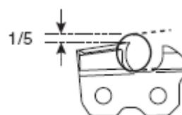
При заточке цепи напильник должен выступать над верхней гранью на  $1/5$  часть своего диаметра (20%). Проще всего выдержать этот размер, если вы будете применять при заточке цепи специальную державку для напильника. После 3-4 заточек цепи обязательно проверяйте высоту ограничителя глубины резания. Опилки от заточки удаляйте куском твердого дерева.
