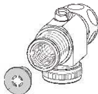
Установка ограничителя расхода
