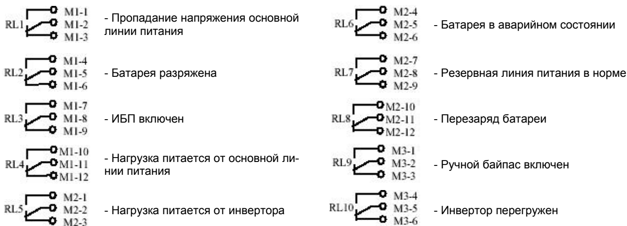
РИСУНОК 7: ОПИСАНИЕ ОТКРЫТЫХ КОНТАКТОВ РАЗЪЕМА DB9.
