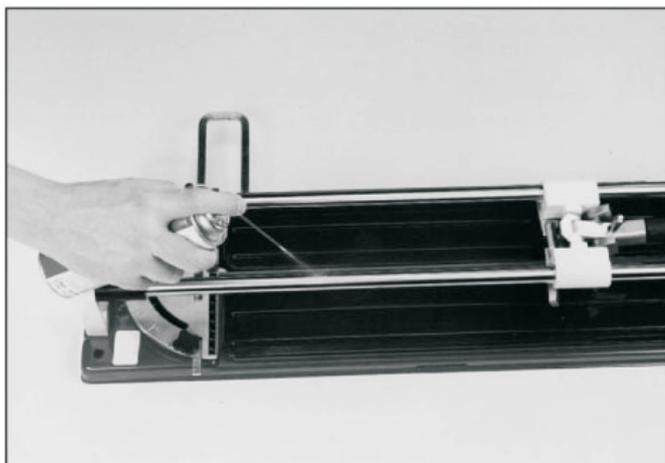
Регулировка тормоза рычага
