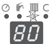
Нажимайте кнопку **MODE** до тех пор, пока не начнёт мигать светодиод у символа ☀️. Нажатием кнопки **-** **+** установите желаемый параметр. Диапазон настройки: --, 45,
