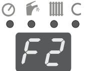
Отображаемое сообщение F2 означает перебой в работе датчика циркулирующей воды. Котёл отключён, обратитесь в авторизованную сервисную организацию.
