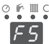
Сообщение об ошибке F5 выводится на дисплей только в том случае, если подключён внешний датчик регулирования котла в соответствии с погодными условиями. Если датчик подключён, сообщение означает обрыв подводящего провода или выход из строя самого датчика. Котёл отключён. Обратитесь в авторизованную сервисную организацию.
