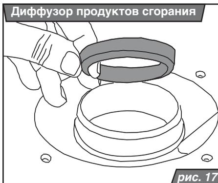
**Предупреждение:** При превышении длины, указанной в таблице 1, необходимо убрать диффузор продуктов сгорания (заслонку) из выхода вентилятора (рис. 17).
