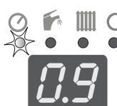
При снижении давления воды в системе отопления до уровня менее 1 бар мигает светодиод у символа ☀️. Котёл всё ещё функционирует, необходимо отрегулировать давление на соответствующее значение 1,2 - 2 бар.
