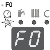
Падение давления циркулирующей воды в системе (ниже значения 0,6 бар). Котёл автоматически отключается – мигает светодиод у символа
