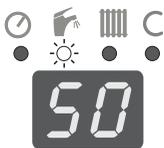
В случае протекания горячей воды для хозяйственных нужд на дисплее котла изображается только требуемая температура. Это состояние показывается светодиодом у символа 🖐️ – диод светится.
