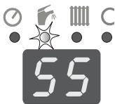
Нажимайте кнопку **MODE** до тех пор, пока у символа 🖐️ не начнёт мигать светодиод. Нажатием кнопки **-** **+** установите желаемый параметр температуры горячей воды для хозяйственных нужд.
