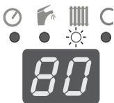
После включения котла главным выключателем на дисплее котла изображается актуальная температура циркулирующей воды. Это состояние показывается светодиодом у символа ☀️ – диод светится.
