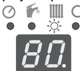
Котёл поддерживает выбранную температуру воды в системе отопления. Переключатель между клеммами для подключения комнатного регулятора удаляется и к
