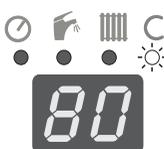
Нажмите кнопку **+**. Включение этой функции сигнализируется светодиодом у символа **C**. Для отключения функции **KOMFORT** вновь нажмите кнопку **+**. Дополнительная информация приведена на стр. 11.
