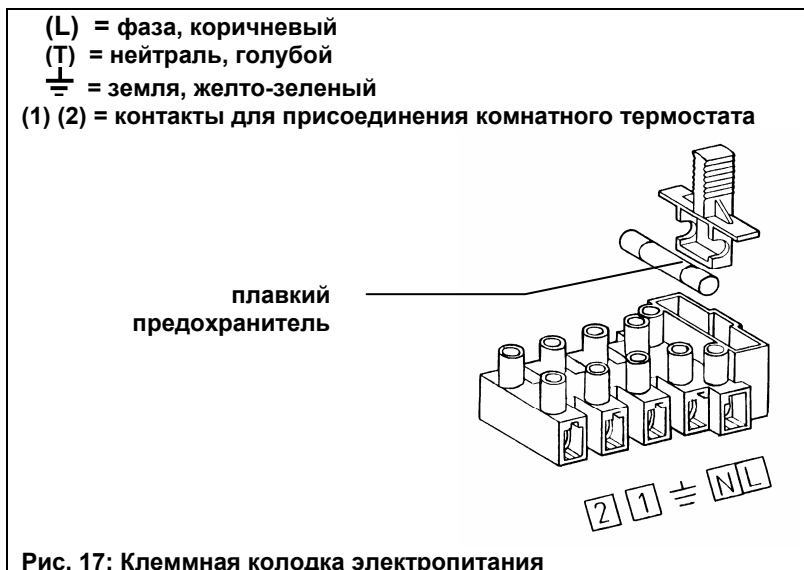
Рис. 17: Клеммная колодка электропитания
