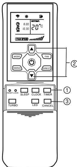
1. Кнопкой таймер (TIMER) выберите таймер включения или таймер выключения. Выбранный режим будет мигать значением часов на дисплее пульта ДУ.
