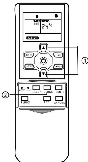
Перед первым запуском кондиционера установите показания часов пульта ДУ. Часовой дисплей на пульте ДУ показывает время и в том случае, если кондиционер выключен.
