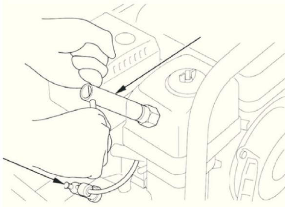
4. Проверьте, в хорошем ли состоянии шайба свечи зажигания, и закрутите свечу рукой, не допуская перекоса.
