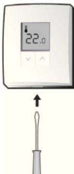
1. Снимите переднюю панель: слегка нажмите плоской отвёрткой на защёлку через щель на нижней стенке корпуса и потяните панель вперед (на себя).
