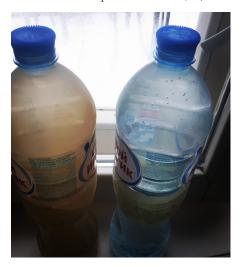
Образцы, подготовленные к отправке в лабораторию «Испытательный центр МГУ». Слева — мутная из-за повышенного содержания железа вода, взятая до фильтра. Справа — фильтрованная
