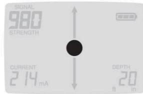
Сигнал звука: когда вы перемещаетесь в пределах 45° от центра излучения электромагнитного поля, высота звукового тона будет изменяться.
