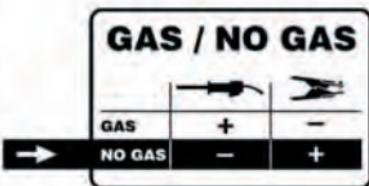
Соедините кабель горелки, поступающий от устройства протягивания проволоки к черной клемме (-). Соедините кабель возврата зажима к красной клемме (+). Закройте отсек с катушкой проволоки.
