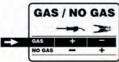
Соедините кабель горелки, поступающий от устройства протягивания проволоки к красной клемме (+). Соедините кабель возврата зажима к черной клемме (-).
