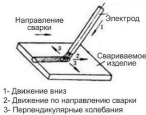
Рисунок 13.4 Три основных направления движения электрода
