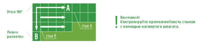
5. Подгонка по разметке краев покрытия **ERFOLG H&G** производится электролобзиком, «болгаркой» или другими режущими инструментами.
