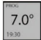
Pokud jste nastavili teplotu Protizmrznutí (7°C), při přechodu do rozsahu programování v režimu ECO na displeji bude se zobrazovat 6°C (automatické snížení na 1°C)
