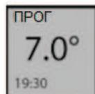
Εάν έχετε ρυθμίσει τη θερμοκρασία του σημείου ψύξης (7°C), τότε στην αλλαγή στο προγραμματισμό στη λειτουργία ECO στην οθόνη εμφανίζεται 6°0 (αυτόματη μείωση για 1°C).
