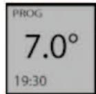
Če ste nastavili temperaturo proti zamrznitvi (7°C), po prestopu na način programiranja ECO na zaslonu se pojavi 6°0 (samodejno znižanje za 1°C).
