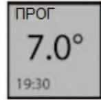
Якщо ви встановили температуру Антизамерзання (7°C), то при переході до діапазону програмування у режимі ECO на дисплеї з'являється 6° (автоматичне зниження на 1°C)
