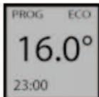
Če vidite na zaslonu PROG ECO, lahko prilagodite nabor programa na način ECO. Za spremembo temperature v razponu ECO, prestopite v meni Temp. ECO (glejte razdelek «Meni na način PROG»).
