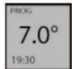
Ha beállította a Fagytól való védelem hőmérsékletet (7°C), az ECO üzemmódban programozásra való átálláskor, a kijelző 6°C-ot mutat (1°C-ra történő automatikus csökkentés)
