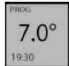
Se você instalou a temperatura Anti-Gelo (7°C), indo para o intervalo de modo de programação ECO no visor aparece 6°0 (*disminuição automática de 1°C*)
