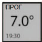
Ако е установена температура Антизамръзване (7°C), то при прехода към диапазон на програмиране в режим ECO на дисплея се появява 6°0 (автоматическо намаляване на 1°0).
