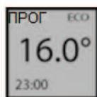
Εάν στην οθόνη εμφανίζει PROG ECO, μπορείτε να ρυθμίσετε το εύρος του προγραμματισμού στη λειτουργία ECO. Για να αλλάξετε τη θερμοκρασία στη λειτουργία ECO, θα πρέπει να πάτε στο μενού Temp. ECO (βλέπε την παρ. «Μενού στη λειτουργία PROG»)
