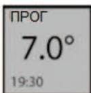
Если вы установили температуру Антизамерзание (7°C), то при переходе в диапазон программирования в режиме ЕКО на дисплее появляется 6°0 (автоматическое снижение на 1°C)
