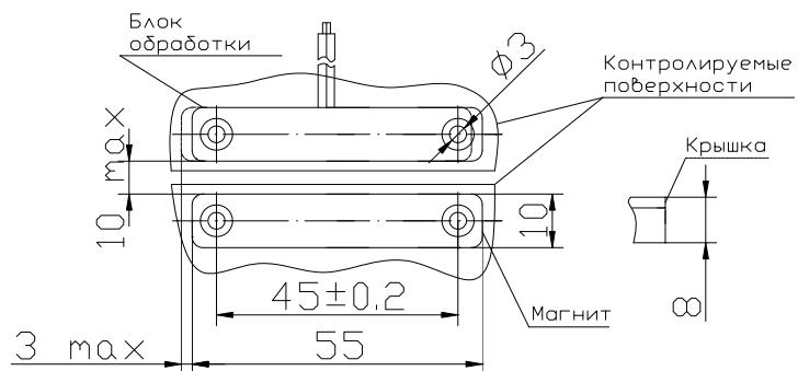
**Рисунок 2 Установочные размеры**
