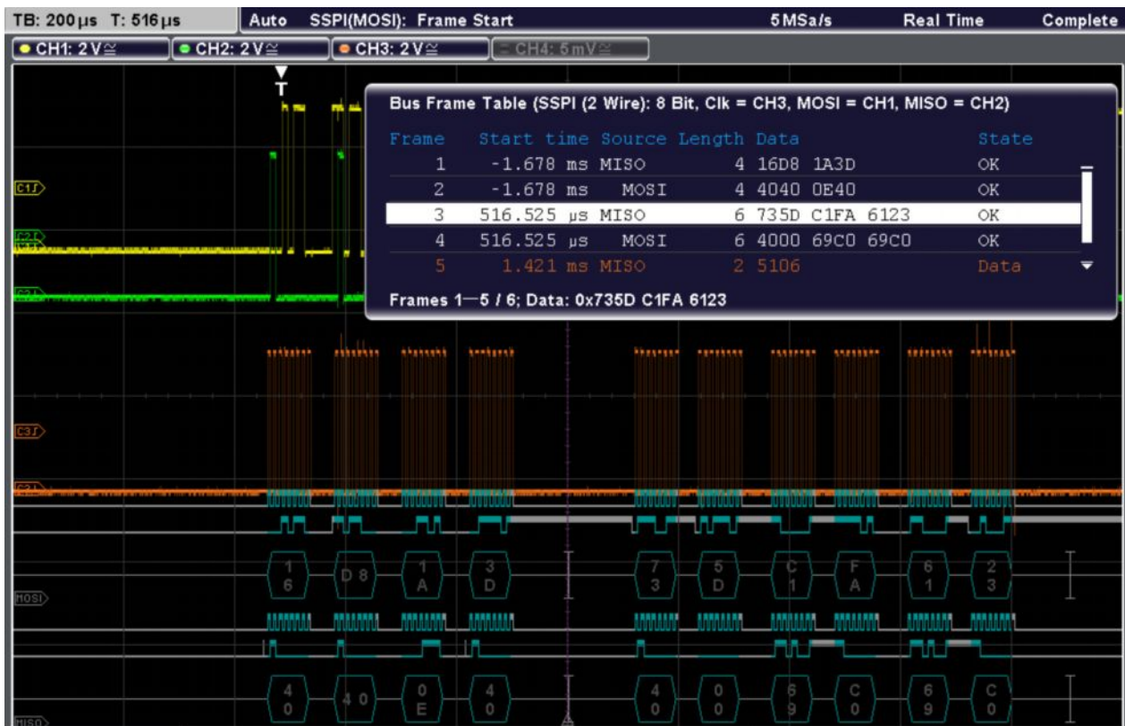
Рисунок 13-3– Декодированный сигнал SSPI с таблицей кадров
