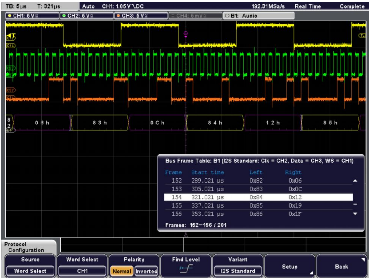
Рисунок 13-22 – Декодированный сигнал I 2 S с таблицей кадров
