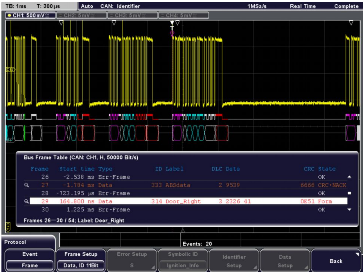
Рисунок 13-13 – Поиск кадров данных с идентификатором длиной 11 битов, результаты поиска отмечены в таблице кадров и на декодированных данных.
