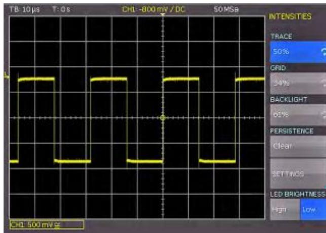
Рис. 7.2 – Меню для настройки яркости индикации сигнала
