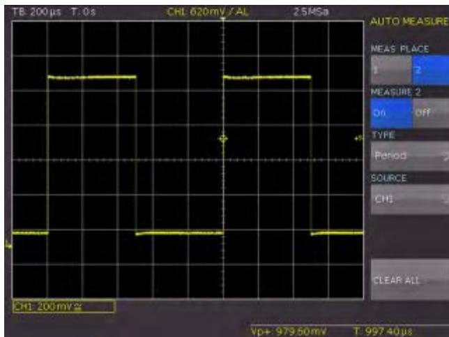
Рис. 8.2 – Меню для настройки автоматических измерений
