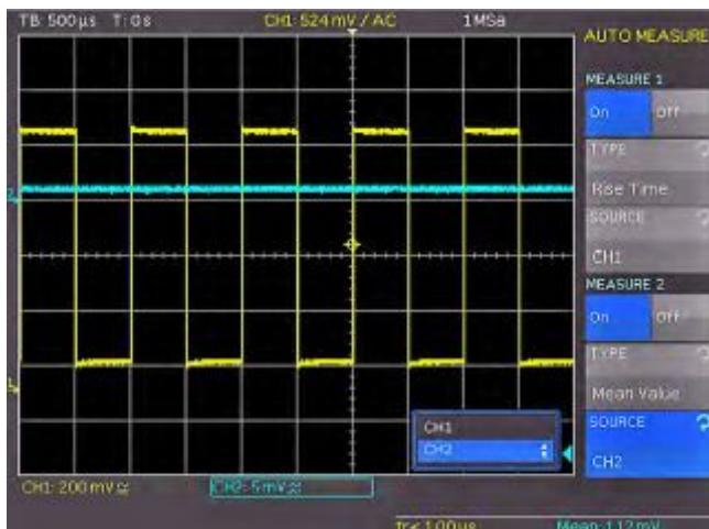
Рис. 3.11 – Измерение параметров для двух источников сигнала
