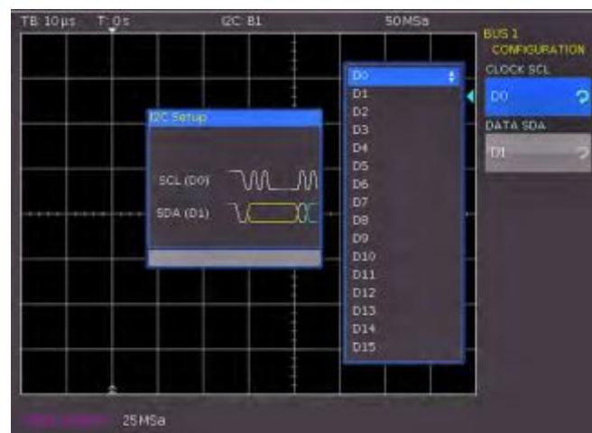
Рис. 12.3 – Меню определения источников I<sup>2</sup>C.
