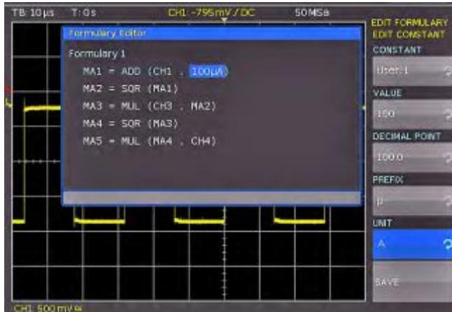
Рис. 9.4 – Ввод констант и единиц измерения
