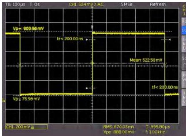
Рис. 3.8 – Измерение параметров в режиме быстрого просмотра
