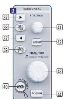
Рис. 3.5 – Область панели управления, содержащая ручку масштабирования ZOOM
