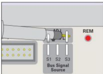
Рис. 4.3 – Правильное подсоединение пробника к выходу регулировки пробника
