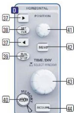
Рис. 5.1 – Панель управления системы горизонтального отклонения
