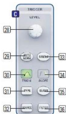
Рис. 6.1 – Область управления системой запуска (синхронизации) на передней панели
