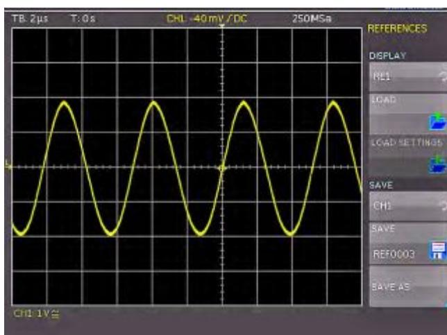
Рис. 10.5 – Загрузка и сохранение опорных значений
