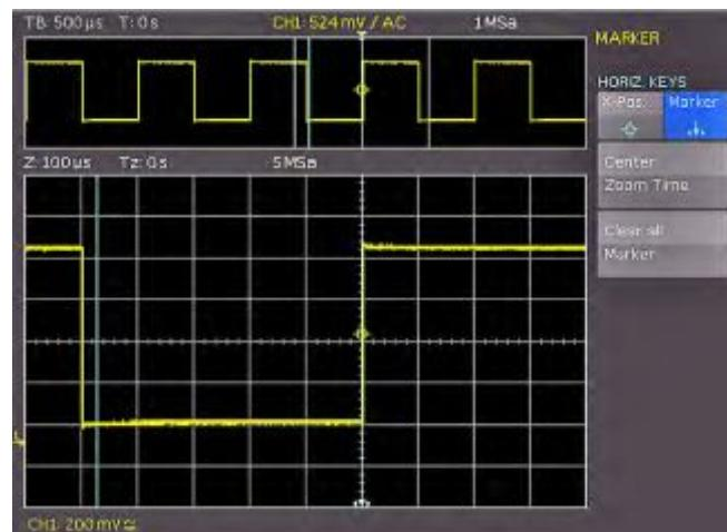
Рис. 5.3 – Маркер в режиме масштабирования
