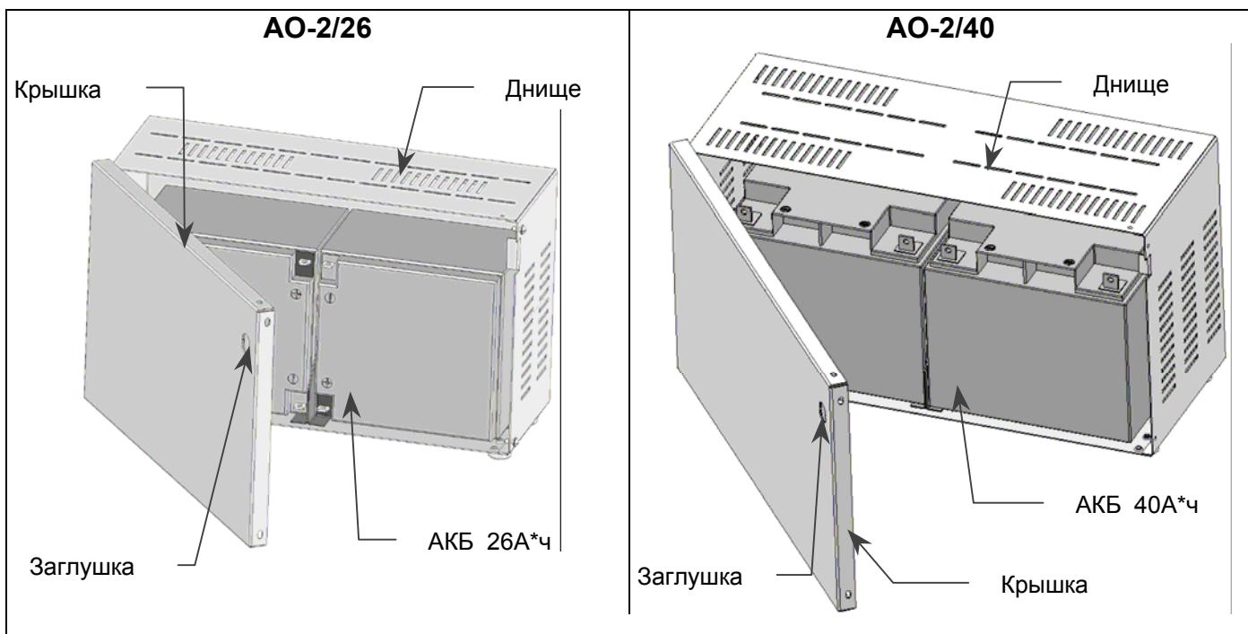
Рисунок 1 Общий вид отсека с открытой крышкой
