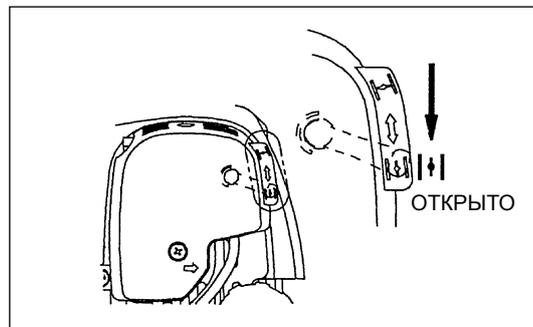
Примечание: - Если тянуть рукоятку стартера несколько раз подряд, когда рычаг дросселирования находится в закрытом положении ("CLOSE"), запуск двигателя будет затруднен из-за перелива топлива.
