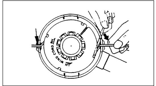
8. Установите крышку на корпус, совместив выступы на крышке с отверстиями в корпусе. Убедитесь, что крышка плотно закреплена на корпусе. Внешний край защелки крышки и внешняя поверхность корпуса должны быть на одной окружности.
