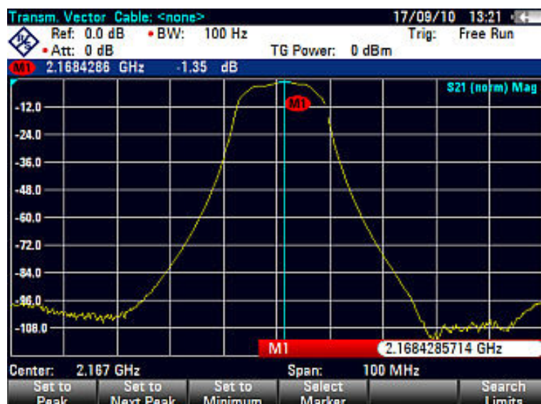
Рисунок 8.8 – Результаты измерения коэффициента прямой передачи фильтра
