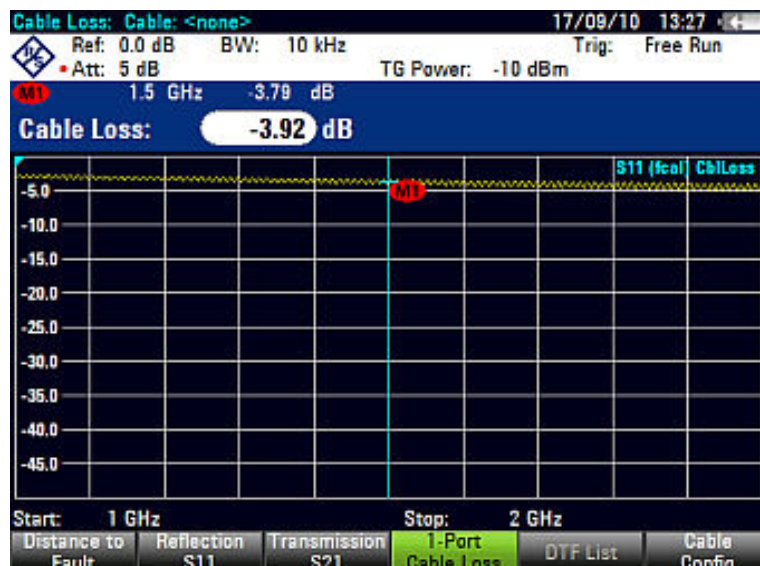
Рисунок 8.7 – Результаты измерения потерь в кабеле
