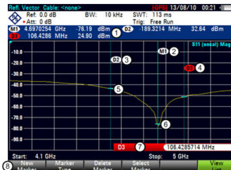
Рисунок 8.10 – Вид экрана анализатора R&S ZVH с активными маркерами.
