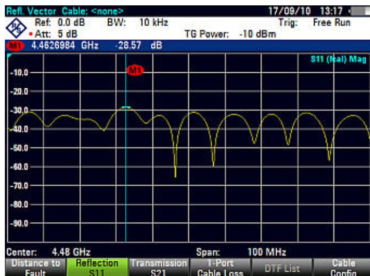
Рисунок 8.5 – Результаты измерения потерь на отражение
