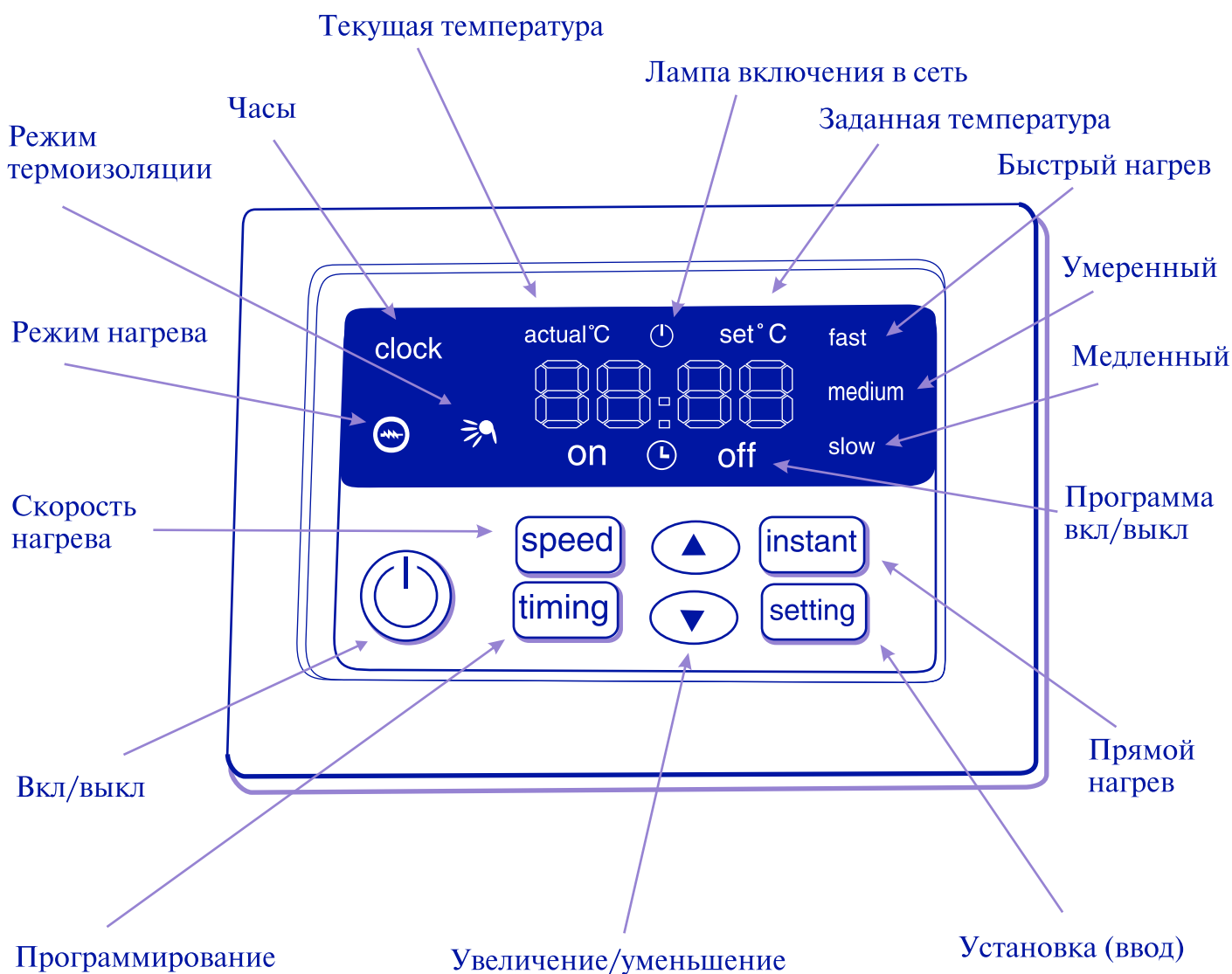
Рис.1. Расположение функциональных кнопок блока управления.
