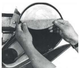
Рис. 11. Установка новой шлифовальной ленты
