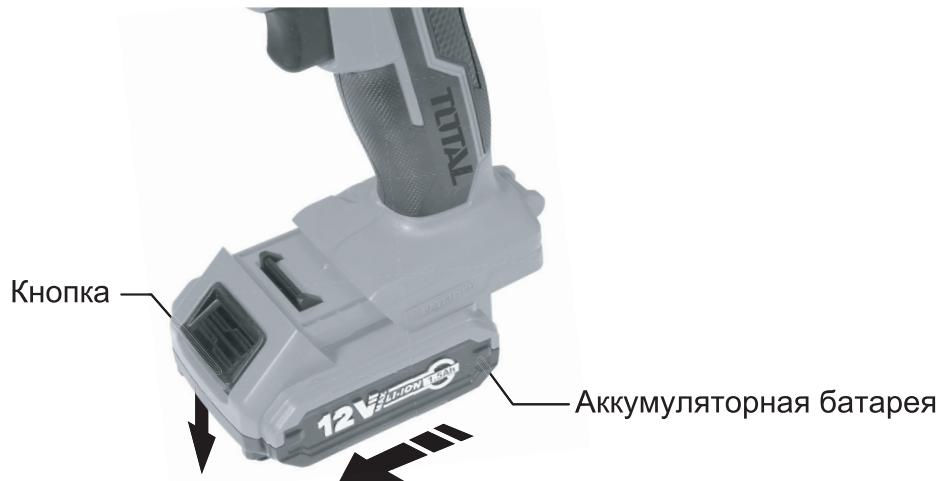
Перед установкой или снятием аккумуляторной батареи, всегда проверяйте, что кнопка включения находится в положении «выключено».
