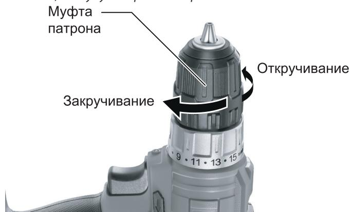
Поверните муфту против часовой стрелки, чтобы открыть зажимы патрона. Поместите биту или сверло в патрон до упора. Поверните муфту по часовой стрелке, чтобы зажать патрон. Для удаления биты или сверла поверните муфту против часовой стрелки.
