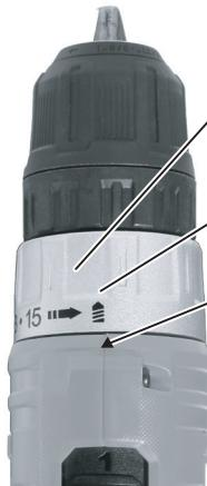
Момент затяжки можно регулировать в 15 положениях, поворачивая регулировочное кольцо так, что бы нужная маркировка режимов регулировки совпадла с указателем.
