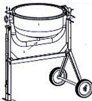
Установите нижний барабан (1) с осью крепления (2) на стойке основания барабана так, чтобы ось вошла в каналы стоек. Ось большого диаметра должна опираться на неподвижную опорную стойку. Зафиксируйте ось в стойках болтами M8 x 70.
