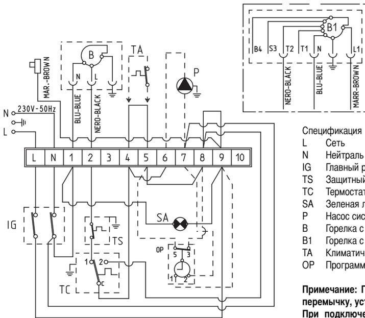
**ВНИМАНИЕ:** Кабель коричневого цвета (изолированный) используется исключительно для подключения горелок с постоянной подачей (типа B1).
