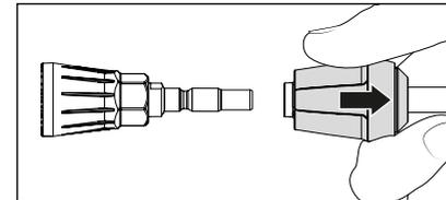
5. Предохранительную гильзу безопасного отключаемого пистолета сначала оттянуть назад, а затем установить соединительный ниппель сопла в соединительную муфту безопасного отключаемого пистолета.
