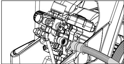
1. Установить всасывающий шланг с всасывающим фильтром (арт. №: 150383).
