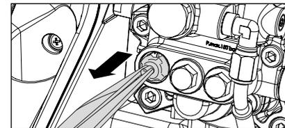
Снимите винт с корпусом клапана и кольцом круглого сечения. Проверьте уплотнительное кольцо на наличие повреждений. В случае повреждения кольцо круглого сечения следует заменить.
