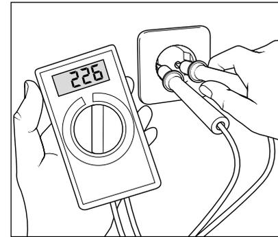
Если к Вашей электрической сети подключено слишком много потребителей, то напряжение и сила тока, имеющиеся в распоряжении, могут значения снизиться. Вследствие этого двигатель аппарата высокого давления не запускается или даже перегорает. Электропитание может быть неудовлетворительным и в том случае, если электрический кабель слишком длинный или слишком тонкий. Слишком длинные удлинительные кабели ведут к падению напряжения и, вследствие этого, к нарушениям в работе и к затруднению пуска.
