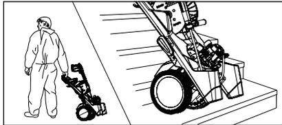
2. Очиститель высокого давления переместить к месту его использования. Очиститель серии X является передвижным очистителем высокого давления с прочной ходовой частью для движения по пересеченной местности и по ступенькам.
