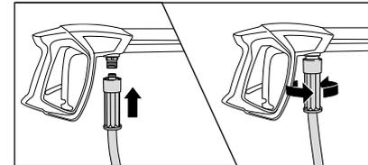
4. Насадить шланг высокого давления на безопасный отключаемый пистолет, крепко и герметично закрутить.
