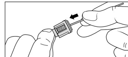
Очистите клапаны при помощи проволоки (канцелярской скрепки) по возможности под струей воды.
