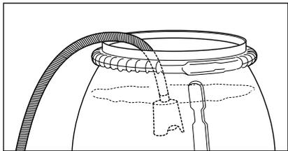
2. Заполненный водой всасывающий шланг ввести в емкость и начать процесс чистки. **Обращать внимание на чистоту воды! Не засасывать воду, содержащую хлор! Не засасывать воздух!**
