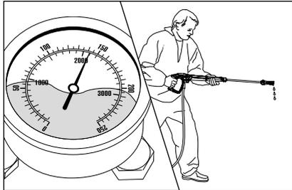
Манометр показывает полное давление. Из сопла не течет или течет слишком мало воды.
