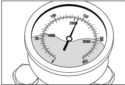
После закрытия безопасного отключаемого пистолета очиститель высокого давления должен отключиться. Манометр должен теперь показывать «0» бар. Если отключение не произойдёт, а манометр будет дальше показывать полное давление, то причиной могут быть утечки у насоса высокого давления, реле давления, шланга высокого давления или безопасного отключаемого пистолета.
