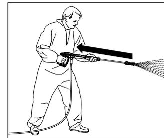
Учтите, что при чистке водой под высоким давлением на копье возникает ощутимая отдача. Поэтому обеспечьте устойчивость его положения (см. технические данные).
