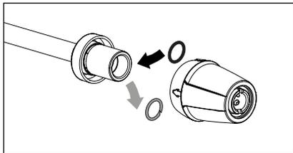
Выключите очиститель высокого давления. Кратковременно включите безопасный отключаемый пистолет для создания давления. Открутите шланг высокого давления, пистолет и копы проверьте уплотнительные кольца. Если уплотнительные кольца неисправные, то кольца круглого сечения сразу же заменить.
