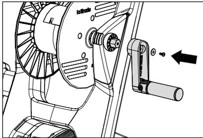
1. У очистителей высокого давления с шланговым барабаном перед их пуском в эксплуатацию необходимо установить приложенную рукоятку. Установите очиститель высокого давления вертикально. Рукоятку установить на шестигранник и закрепить прилагаемыми шайбой и винтом.
