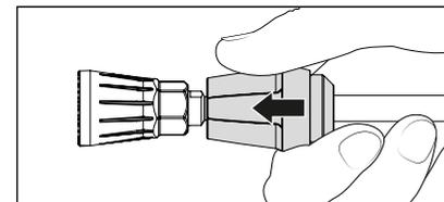
6. После установки соединительного ниппеля сопла отпустить предохранительную гильзу и обеспечить надежную посадку сопла. **Соединительный ниппель регулярно смазывать смазкой, не содержащей кислотных веществ.**
