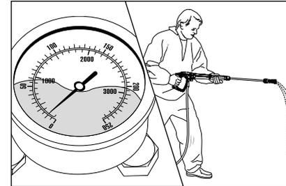
Манометр несмотря на установку максимального давления, показывает низкое давление. Из сопла выходит непостоянная струя. Вибрация шланга высокого давления. (В манометре, изготовленном из нержавеющей стали, нет воды, речь идет о глицерине для демпфирования вибрации стрелки.)
