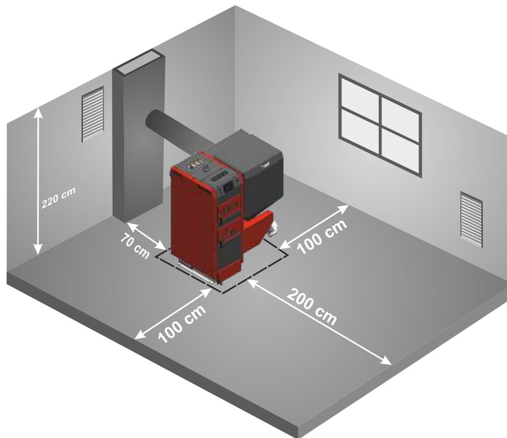
Рисунок 8.1 Минимальные расстояния при установке котла в котельной
