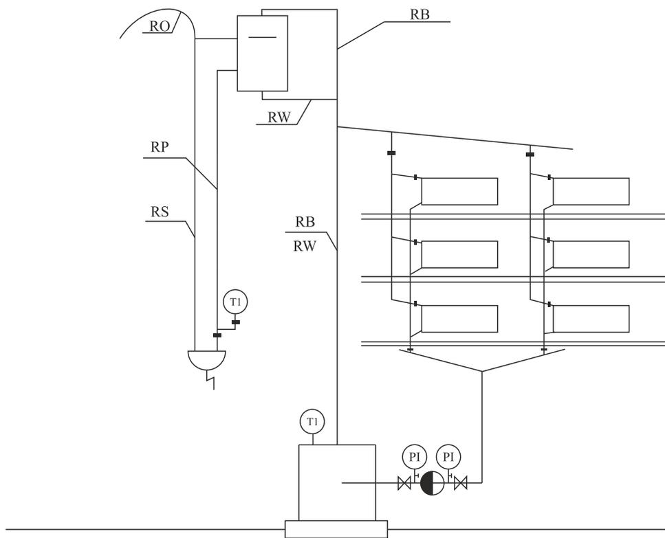
Рисунок 8.2.1 Схема подключения котла к отопительной системе
