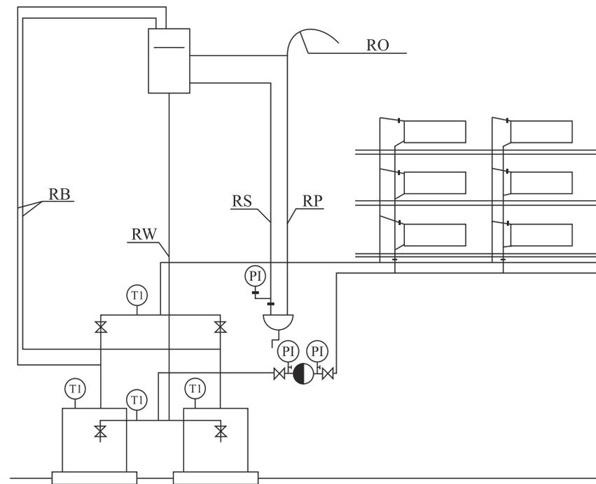
Рисунок 8.2.2 Схема подключения котлов к отопительной системе
