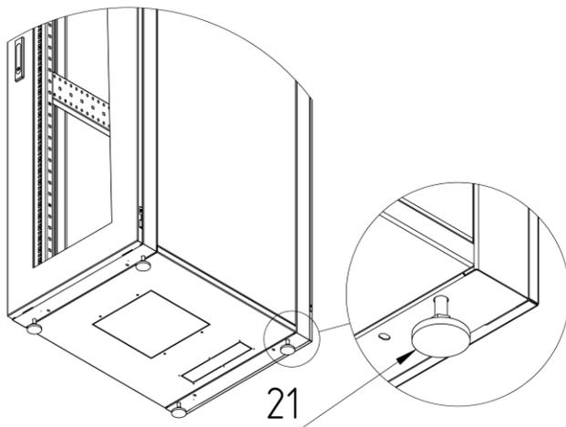
Винтовые опоры (21) устанавливаются внизу шкафа по углам. Винтовые опоры способны обеспечить стабильную опору в случае, если пол в выбранном помещении неровный, однако они не предназначены для обеспечения устойчивости на поверхности, имеющей сильный уклон.
