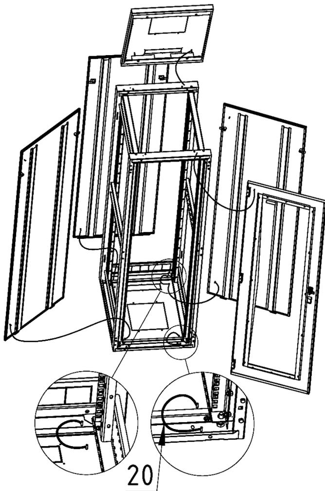
9.1 Телекоммуникационный шкаф имеет систему заземления, реализуемую с помощью проводов заземления (20), заземлены все элементы шкафа, все детали соединены между собой или с шиной заземления.
