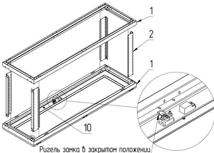
1.1 Для удобства сборки расположите раму (1) в сборе с дверью (10) на поверхности пола.
