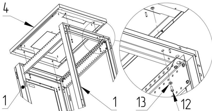
1.1 Крышу (4) сориентируйте кабельным вводом к тыльной стороне собираемого шкафа и закрепите на рамах (1) предварительно.
