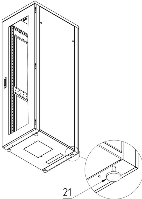
Винтовые опоры (21) устанавливаются внизу шкафа по углам. Винтовые опоры способны обеспечить стабильную опору в случае, если пол в выбранном помещении неровный, однако они не предназначены для обеспечения устойчивости на поверхности, имеющей сильный уклон.
