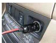
3. Штекер прикуривателя: позволяет поддерживать заряд аккумулятора через выходной разъем 12 В в автомобиле. Убедитесь, что прикуриватель отключен кнопкой OFF.
